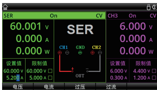
3 串并联一键设置: 串联输出
